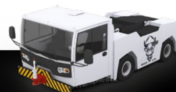
»BISON« D 370 101 hp | 23,600 lbf | MTOW ≤ 275 000 lbs EPA TIER 3 DE EE. UU. | EPA TIER 4 DE EE. UU.
